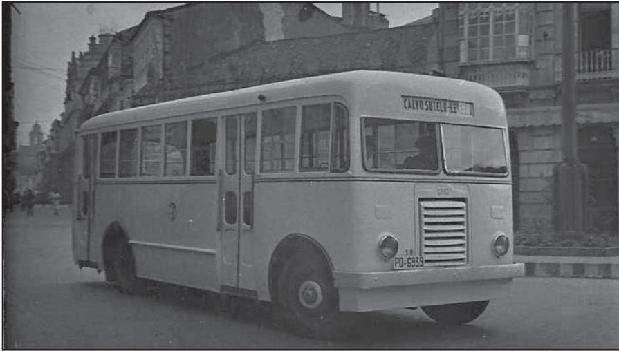
Autobús nº 3 de TEP. No ano 1949 adquirese na Aduana de Vigo un bastidor GMC denominado "de Guerra" con un chasis CCKW353270578-A2 e motor 270359020 de 6 cil y 26 HP, con capacidade para 150l de gasolina. Será carrozado nos talleres de T.E.P para transportar 23 prazas sentadas e dúas plataformas de 14 persoas cada unha. Poñerase en servizo o 30 de setembro de 1950 coa matrícula PO-6939 para la liña 1. Arquivo APSA.
