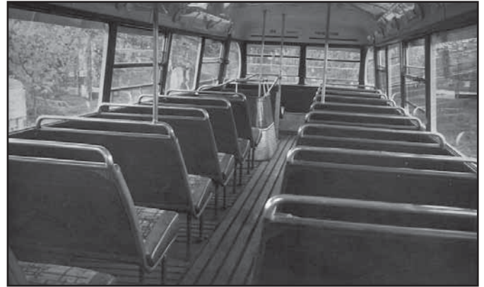
Trolebús BUT, chasis 8168, motor 3496. Transformado con portas á dereita e subida de viaxeiros por detrás do condutor. O piso superior, tras a reforma, contaba con 40 prazas sentadas. Arquivo APSA.
