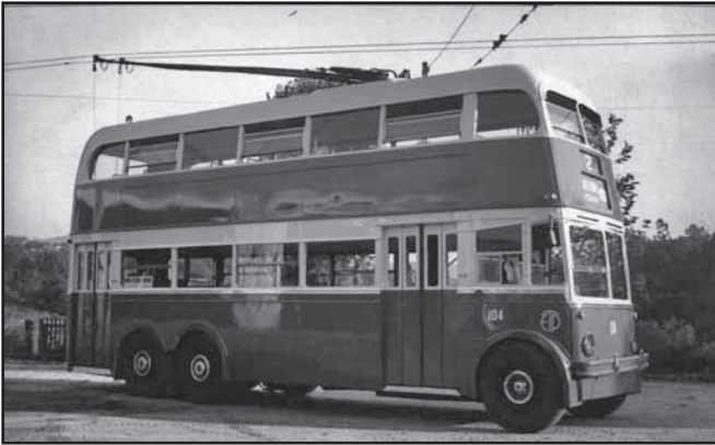
Trolebús BUT, chasis 8168, motor 3496. Transformado con portas á dereita e subida de viaxeiros por detrás do condutor. O piso superior, tras a reforma, contaba con 40 prazas sentadas. Arquivo APSA.
